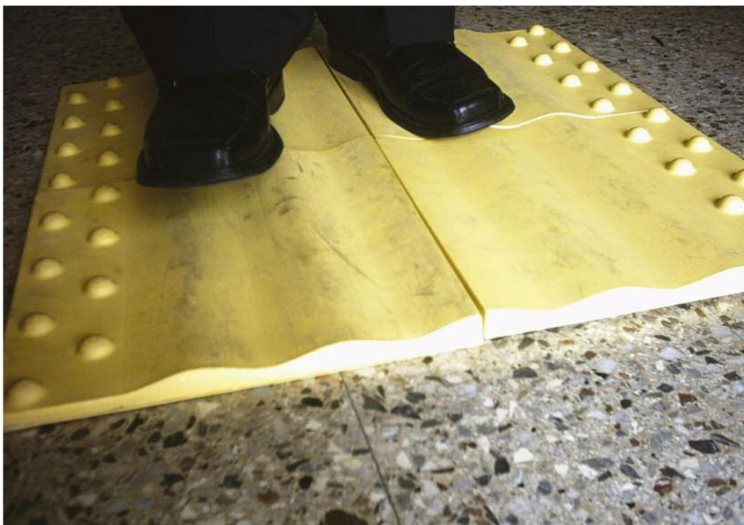
*Primo elaborato della pavimentazione composto da 5 onde sinusoidali e semisfere per il margine*
